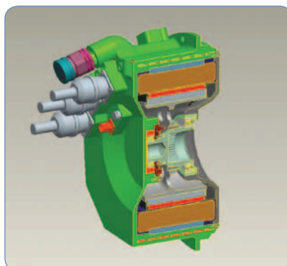
Электрический стартер/генератор мощностью 200 кВт
